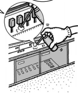
●金属表面に薄い被膜を作って保護し再酸化を防止します。
