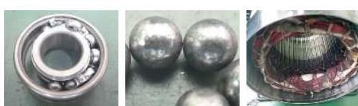
F側のペアリングが原因でモーターがロック。保持器が大きく破損。内部のボールの1つが摩耗し表面に凹凸が発生。モーターハウジング内には摩耗粉が堆積。
