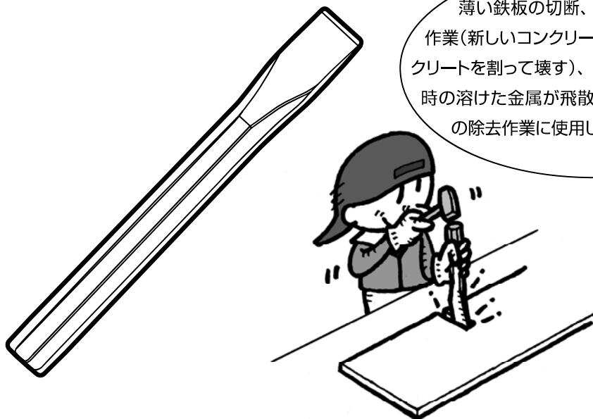
薄い鉄板の切断、コンクリートのハツリ作業(新しいコンクリートを敷くために、古いコンクリートを割って壊す)、溶接時のスパッタ(溶接作業時の溶けた金属が飛散して粒状に固まつたもの)の除去作業に使用します。
